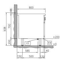
Electrical inlet (power) Equipotential screw
